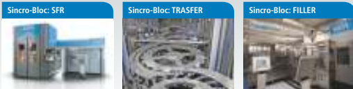
Sincro-Bloc-SFR Il s'agit d'une moderne solution intégrée pour le soufflage, le remplissage et le bouchage de bouteilles en PET qui peut assurer plusieurs avantages d'un point de vue de l'efficacité de production, de la grande flexibilité, de la réduction de l'investissement. Sincro-Bloc-TRASFER La flexibilité du système permet la combinaison de tous les modèles de soufflage avec la gamme de remplisseurs, suivant le type de produit final à traiter. Sincro-Bloc-FILLER Il s'agit d'une moderne solution intégrée pour le soufflage, le remplissage et le bouchage de bouteilles en PET qui peut assurer plusieurs avantages d'un point de vue de l'efficacité de production, de la grande flexibilité, de la réduction de l'investissement.
