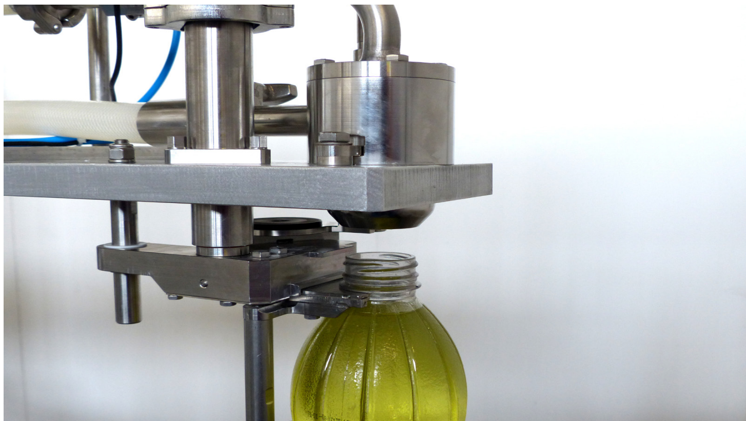
Fig 4- Foto di dettaglio della valvola di riempimento Flextronic W
