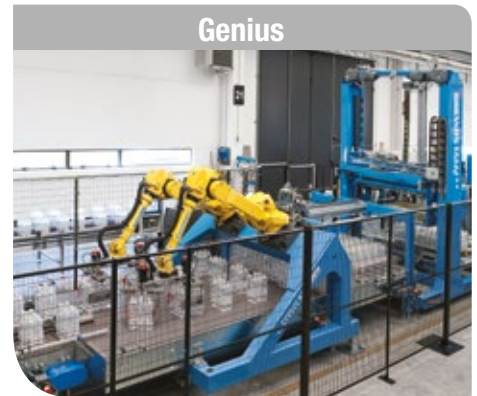
Genius Sistemi completi di palettizzazione/depalettizzazione tradizionali con alimentazione dall'alto e dal basso.
