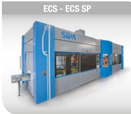
ECS - ECS SP Sistema integrato dalla resina di plastica fino al contenitore finito. Bassa, media e alta velocità: da 1.000 a 36.000 bottiglie/ora.
