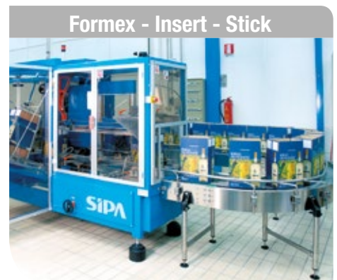
Formex - Insert - Stick Linee complete di incartamento per la preparazione e chiusura di cartoni, anche con inserimento di alveari.
