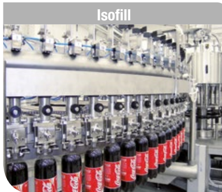
Isofill Riempricce meccanica isobarica a livello idonea per il riempimento di Soft Drinks, acqua minerale gassata e non.
