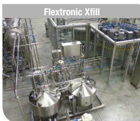
Flextronic Xfill Innovativa configurazione con integrazione mixer-riempitrice: in caso di riempimento di prodotti gassati non è presente il serbatoio prodotto a bordo macchina, si utilizza quello tampone del mixer come serbatoio prodotto della riempitrice.
