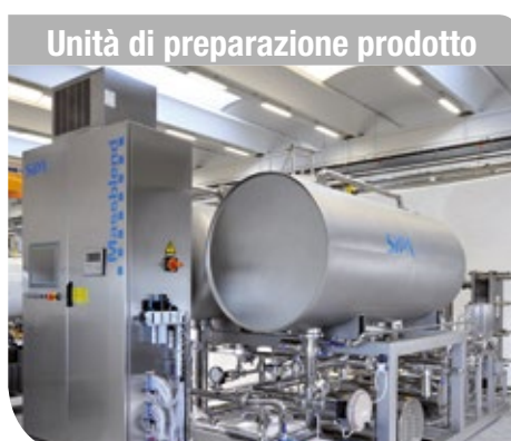
Unità di preparazione prodotto Unità di deareazione e carbonatazione, Unità di miscelazione e carbonatazione a controllo massico, unità C.I.P., Unità di miscelazione in linea multi-componente, unità di pastorizzazione, unità di carbonatazione.
