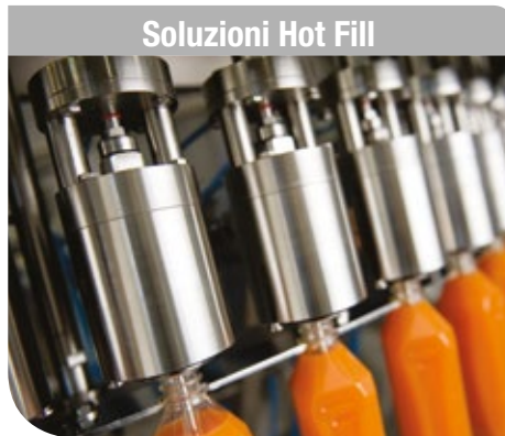
Soluzioni Hot Fill Gamma completa di riempitrici meccaniche ed elettroniche per prodotti limpidi o con polpe, inclusa l'integrazione con la dosatrice di sacs per le applicazioni a doppio flusso.
