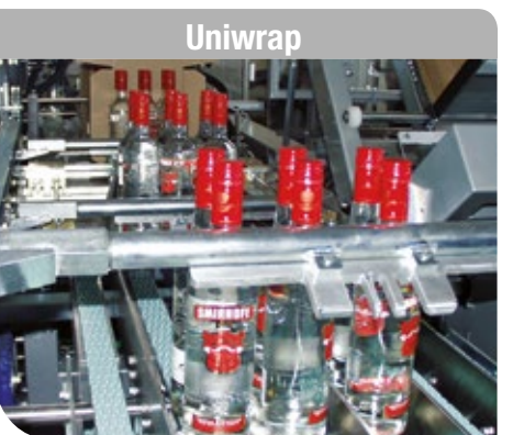
Uniwrap Incantatrici con sistema wrap-around a movimento continuo. Dispositivo brevettato di inserimento alveari a richiesta.
